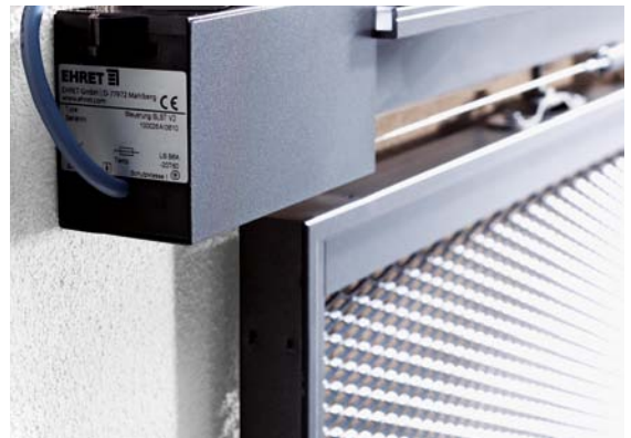
EHRET Voletronic Solarantriebe (12V) bewegen Schiebeläden bis max. 120 kg Gewicht. Die Stromversorgung erfolgt direkt über das Solarpanel. Ein integrierter Akku stellt den Betrieb auch ohne Sonneneinstrahlung sicher.
